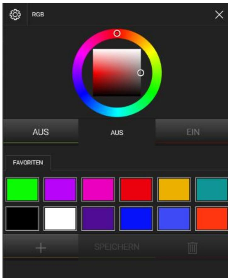
Über die dargestellten grafischen Elemente ist es möglich, die gewünschte Farbe der RGB-Lampe auf einfache Weise auszuwählen: während im Ring das Farbspektrum gewählt werden kann, erlaubt das Viereck im Anschluss die genaue Auswahl der Helligkeit und Sättigung der Farbe. Wenn verfügbar, kann über die Slider-Skala im unteren Bereich auch die Helligkeit der RGB-Lampe selbst eingestellt werden.
