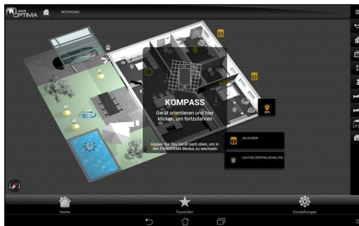
Wenn nun das mobile Gerät in eine andere Richtung gedreht wird, richtet sich das Hintergrundbild der Räumlichkeit samt allen eingefügten Objekten immer in die zuvor gespeicherte Richtung aus. Dies erlaubt eine sehr intuitive Orientierung in dem entsprechenden Raum.
