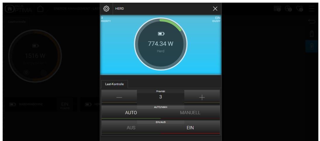
Wie im Screenshot ersichtlich ist, kann eine Last auch in den MANUELLEN Modus versetzt werden; in diesem Fall wird die Last nicht durch die Last-Kontrolle von OPTIMA deaktiviert, sondern kann nur vom Benutzer manuell geschaltet werden (kann hilfreich sein, um Lasten temporär vor der Zwangsabschaltung auszunehmen).
