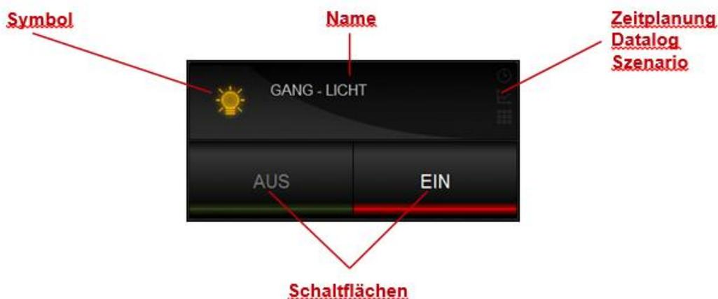
Das SYMBOL stellt den gedachten Einsatzzweck des Objekts in grafischer Form dar und verändert sich in Abhängigkeit des aktuellen Status (ein, aus, offen, zu usw.). Der NAME beschreibt die Funktion des Objekts und erlaubt eine einfache Identifizierung der Funktion innerhalb der Anlage.
